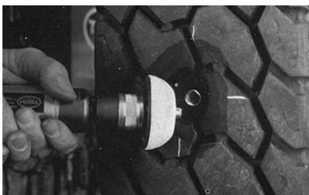
14. Обработайте покрышку с внешней стороны вокруг повреждения по периметру;
