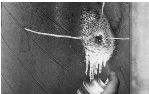
6. Очистка зоны повреждения, спец. жидкостью.
