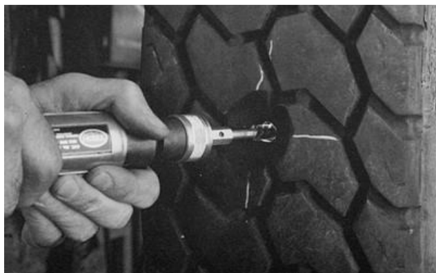
13. Обработка краев пореза, предание нужной текстуры;
