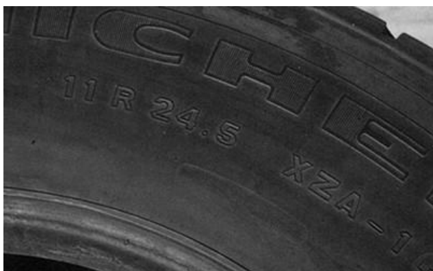
18. По сведениям, указанным на боковой поверхности покрышки, определяется ширина профиля покрышки и тип герметизации;
