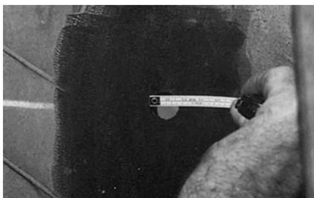
17. Измерение максимального поперечное сечение поврежденного корда;
