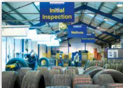
1) Процесс осмотра каркаса
